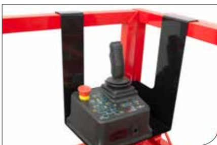
Joystick ergonomico e rimovibile che può essere rimosso dopo aver terminato il lavoro
