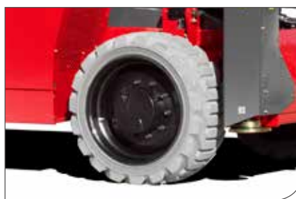
Ampi pneumatici fuoristrada anti-traccia per una migliore aderenza al suolo
