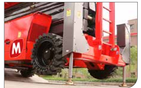
Stabilizzatori idraulici con livellamento automatico
