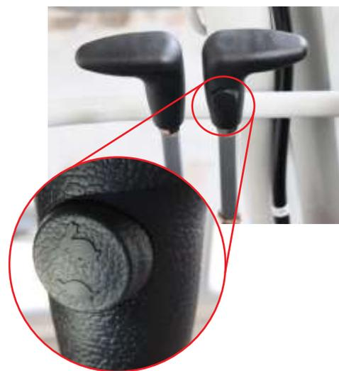
Pulsante seconda velocità sulla leva di traslazione destra
